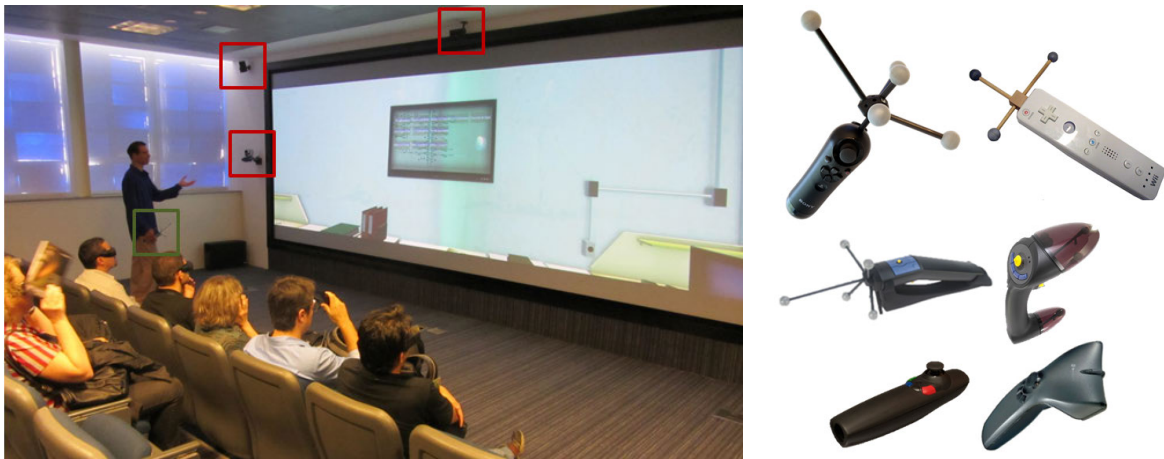
Figura 6.1: Ejemplo de un entorno acotado y restringido para la interacción con una pantalla de gran formato. En la foto se resaltan los dispositivos apuntadores (cuadro verde) y las cámaras usadas para identificar su posición exacta en la sala (cuadros rojo). La fotografía corresponde a una sala de visualización de Petrobras en Río de Janeiro, visitada durante el evento SRV 2012. Las imágenes a la derecha muestran diferentes dispositivos apuntadores usados para interactuar, tanto con una pantalla de gran formato, como con una caverna de inmersión, en inglés Cave Automatic Virtual Environment (CAVE) . Los dos de arriba corresponden a dispositivos de bajo costo contruidos con controles de videojuegos, los demás son dispositivos comerciales.
