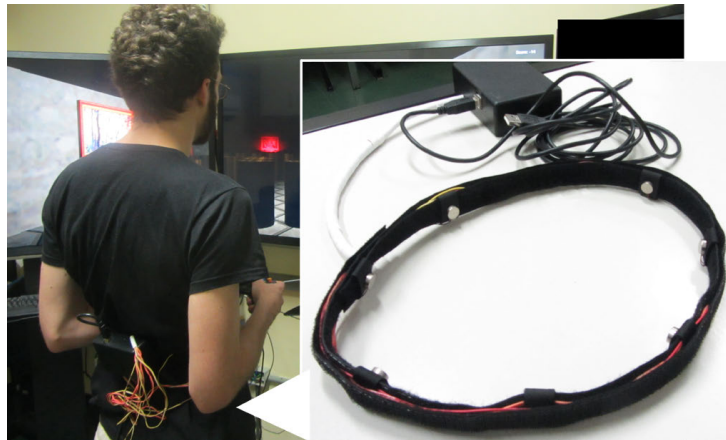
Figura 5.2: Artefacto de táctil de PA. Se observa a un usuario usando el cinturón de vibración y un detalle del dispositivo que muestra los motores ubicados a cada lado.
