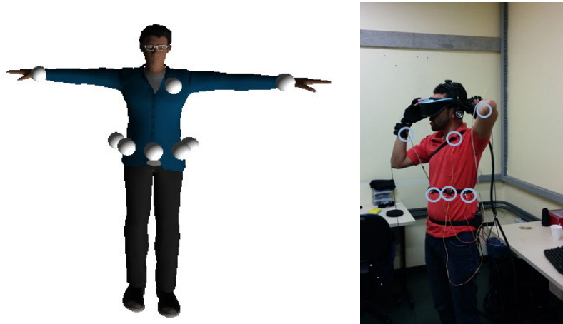
Figura 8.2: Dispositivo de comunicación vibro-táctil diseñado, se observa la fotografía de una persona usando el chaleco táctil, y un esquema que indica la posición de cada motor en el cuerpo del usuario. Observe los puntos esquematizados, resaltados como círculos azules en la fotografía. Se resalta que los puntos donde están ubicados los motores son los mismos puntos de activación usados para enviar a la señal táctil.
