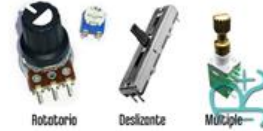
Tipos de potenciómetros según su uso
