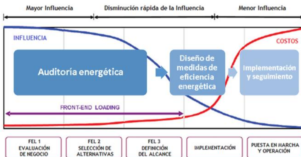
Figura 9. Relación fases del proyecto de eficiencia energética con la metodología FEL. Fuente: Propia.
