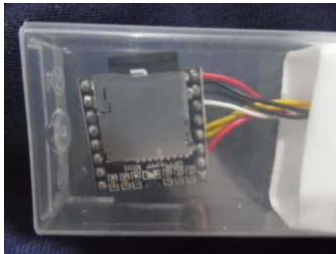
Figura 5.5 Módulo de sonido. Fuente: Elaboración propia.
