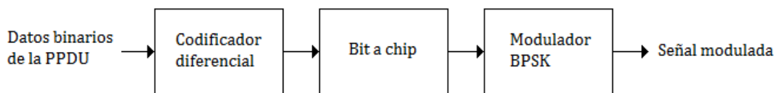
Figura A.3. Modelo funcional de referencia capa PHY BPSK
