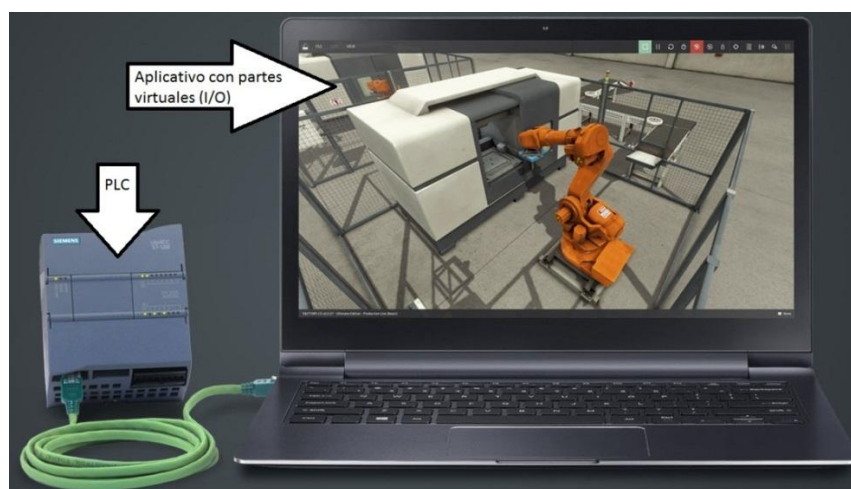
Figura 5.1. Descripción del aplicativo Factory I/O ( https://factoryio.com ).
