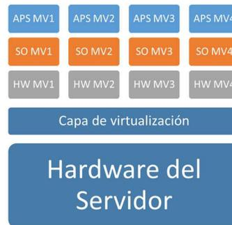
Figura 2.2 Arquitectura general de virtualización sobre un servidor.
