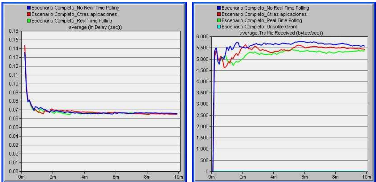
a. Retardo b. Tráfico Figura 84. Efectos de la variación de los flujos de servicio sobre http
