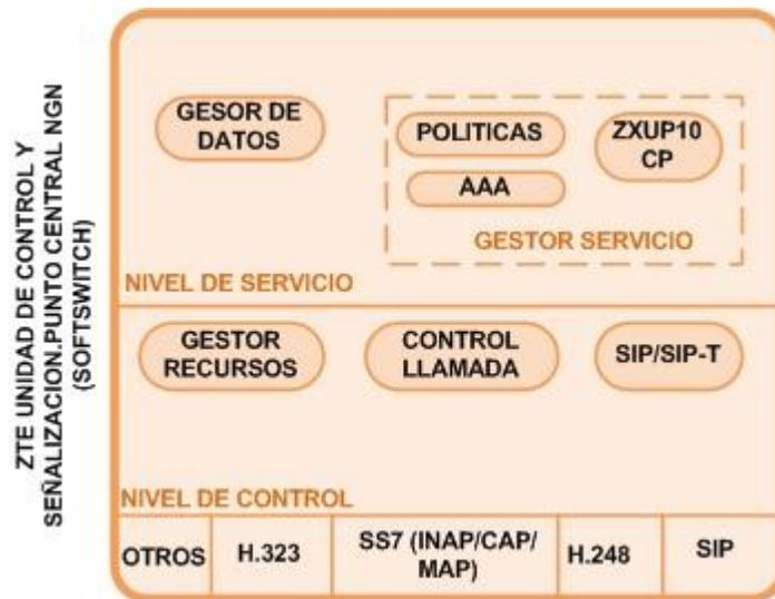
Figura 20 Componentes lógicos del Softswitch Fuente: ZTE
