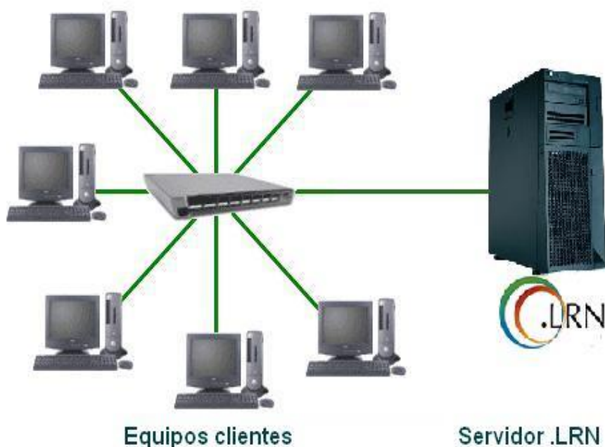
Imagen 0-8: Implementación interna de .LRN en JOMACO
