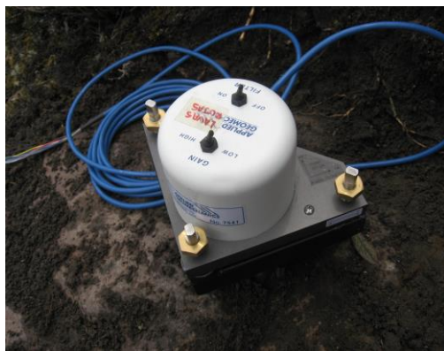
7a. Inclinómetro electrónico estación OVSPo
