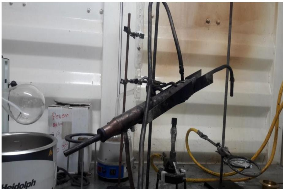
**Fotografía 3. Esquema del equipo para el ensayo de destilación de emulsiones asfálticas (Fuente propia)**
