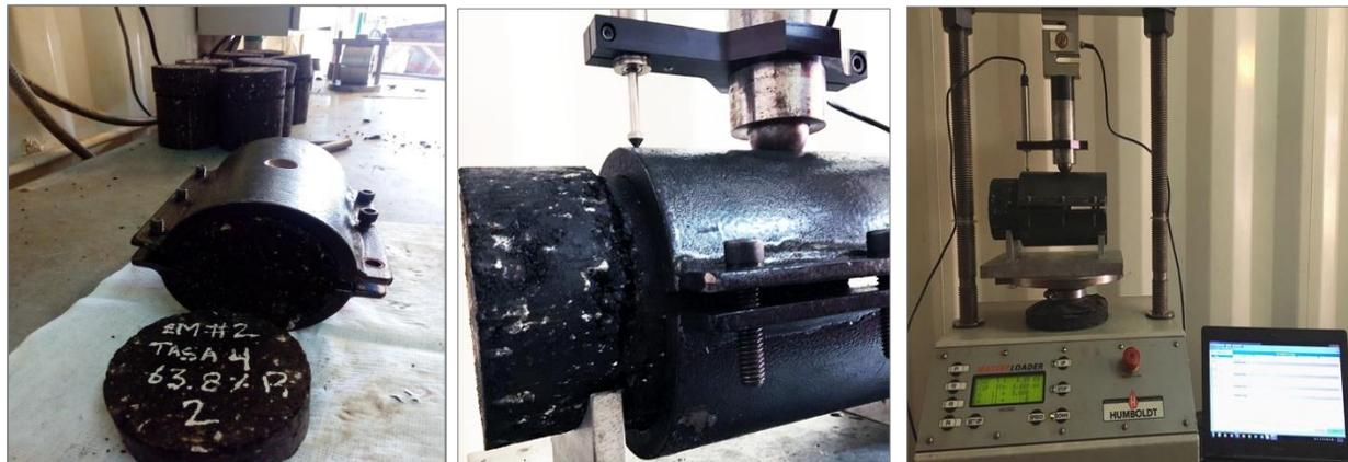
**Fotografía 9. Proceso del ensayo de corte NLT 382/08**
