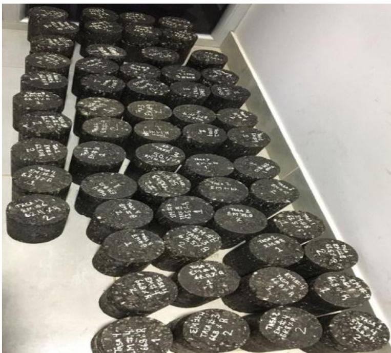
**Fotografía 6. Especímenes cilíndricos de diámetro 100mm para ensayo de corte (Fuente propia)**
