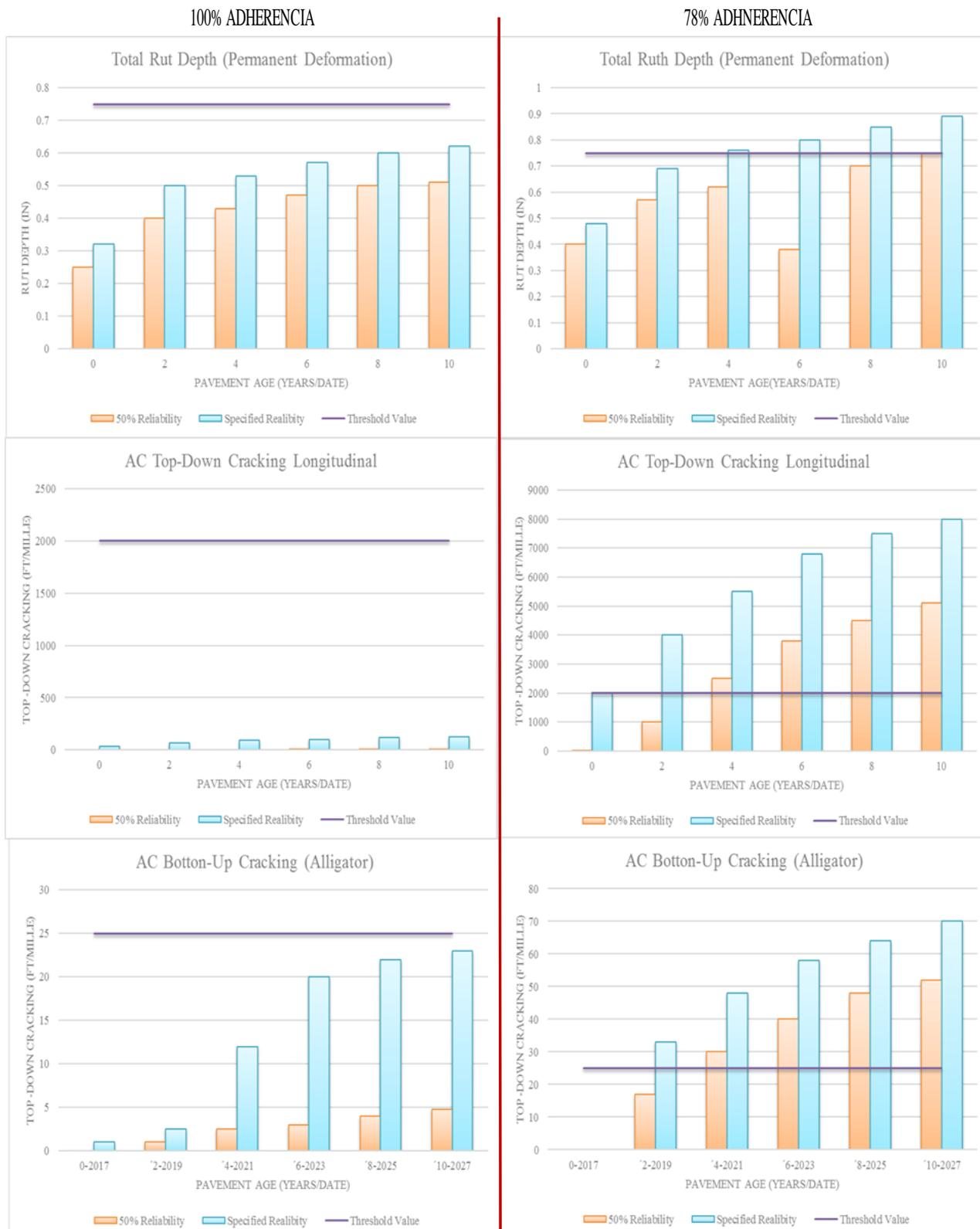
Figura 13. Gráficas de acumulación de daño, modelación interfaz con total adherencia y modelación interfaz con 22% de afectación (Fuente propia).
