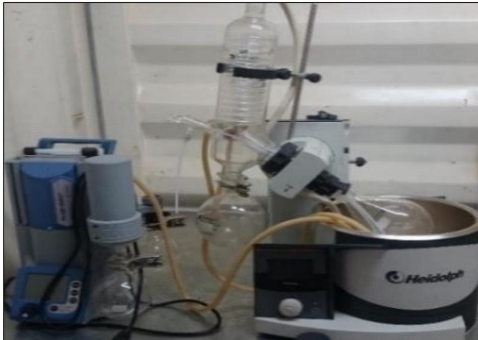
**Fotografía 4. Evaporador rotatorio y sistema de recuperación (Fuente propia)**
