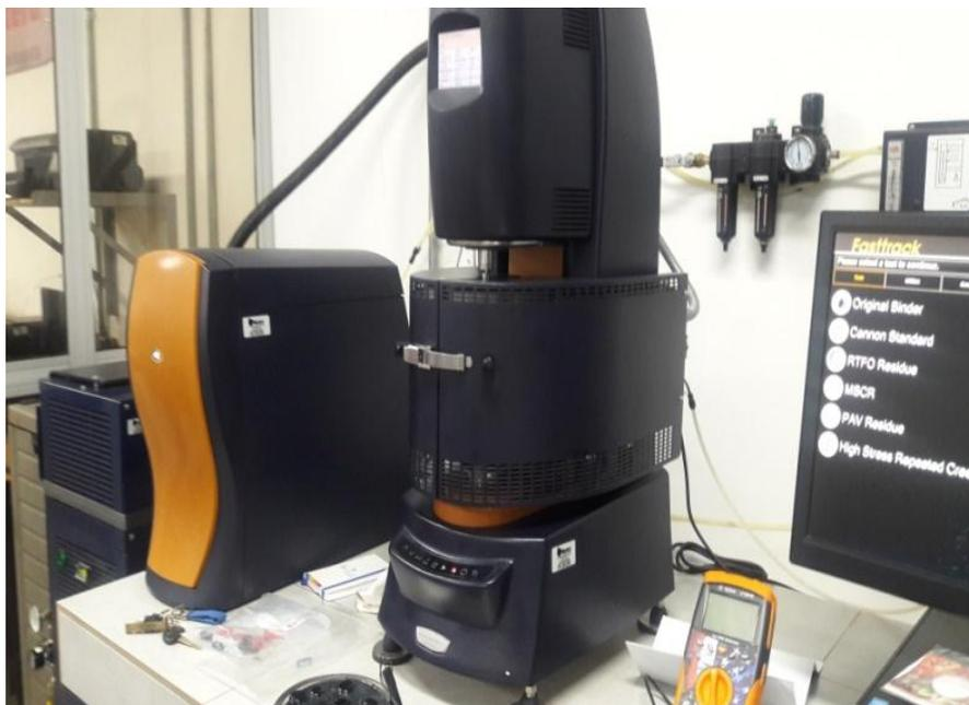
**Fotografía 5. Reómetro de corte dinámico (Fuente propia)**
