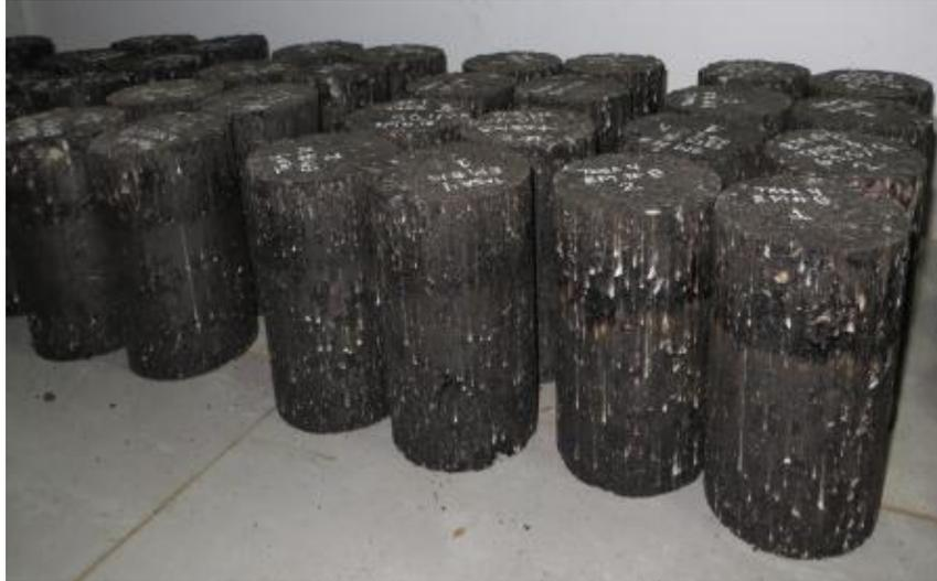
**Fotografía 7. Especímenes compactados unidos mediante el riego de liga (Fuente propia)**
