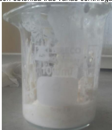
Figura 8. Muestras de almidón obtenida tras varias centrifugaciones.
