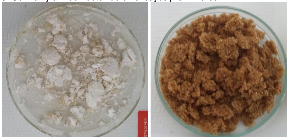
Figura 10. Germen y almidón obtenido en ensayos preliminares
