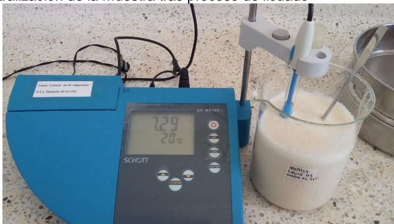
Figura 6. Neutralización de la muestra tras proceso de licuado
