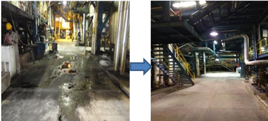
Se realizó limpieza y mantenimiento a las bombas del primer nivel de centrifugas, para evitar vertimientos de material (meladura) y a su vez la utilización de agua caliente para mandarlo por las canaletas, pues el uso de agua caliente representa un peligro para los operarios que manipulaban las mangueras. A continuación se muestra el antes y después de esa área (Ver figura 36).
