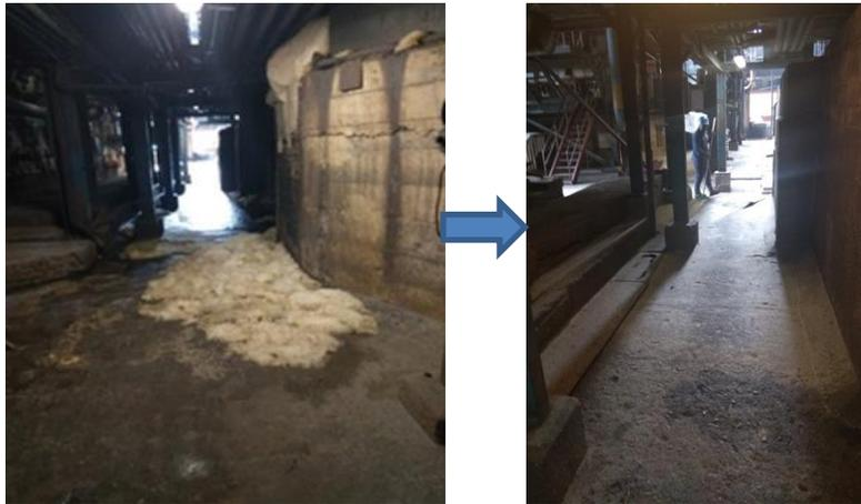
En el área de centrifugas habían muchos regueros de meladura por las frecuentes fugas de los equipos. Después de realizar mantenimiento a dichos equipos y limpiar la zona quedó como se muestra a continuación (ver figura 35):
