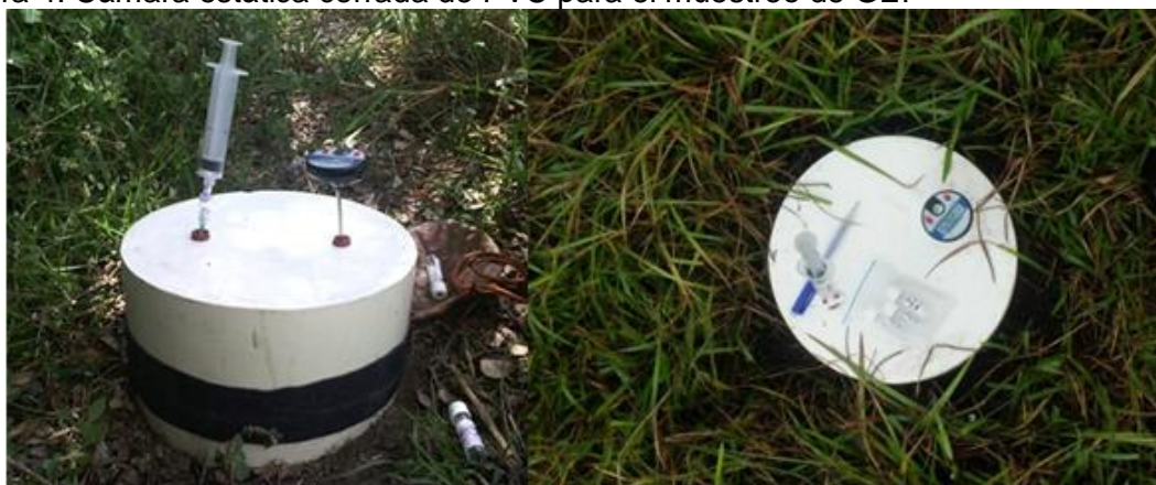
Figura 4. Cámara estática cerrada de PVC para el muestreo de GEI
