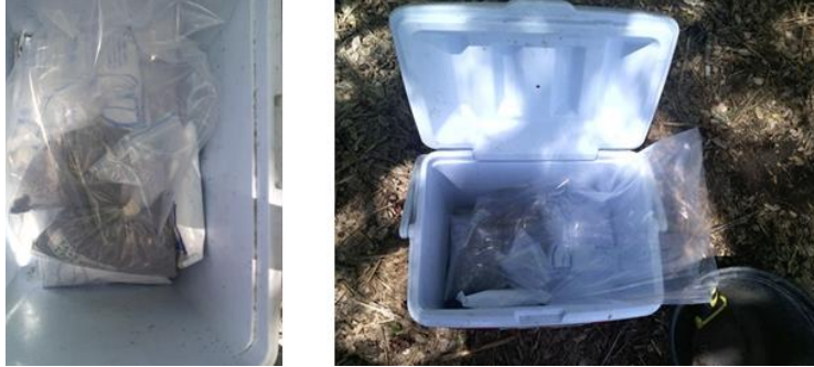
Figura 15. Almacenamiento de muestras para su conservación
