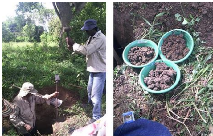
Figura 17. Penetración del barreno en el suelo y muestras de suelo tomadas a diferentes profundidades
