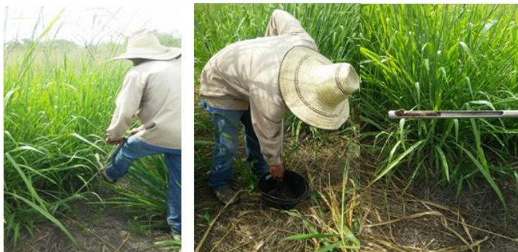
Figura 13. Penetración del barreno en el suelo y obtención de la muestra
