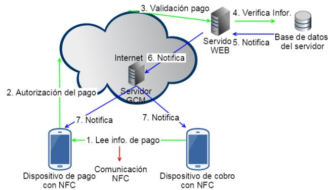
Figura 3.4: Arquitectura centralizada. Adaptada de [113].
