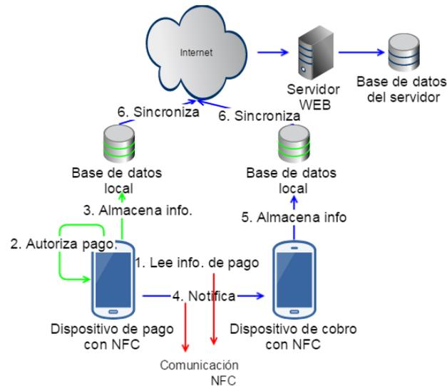
Figura 3.5: Arquitectura semi-distribuida. Adaptada de [113].
