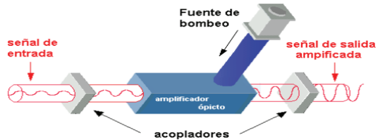
Figura A1.9 Funcionamiento básico de un amplificador óptico de emisión estimulada. Fuente: [29].
