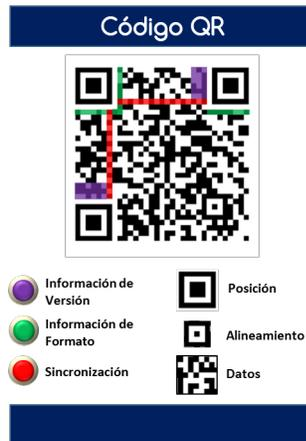
Figura 2.5: Detalles de Funcionamiento de Código QR. Fuente [31]
