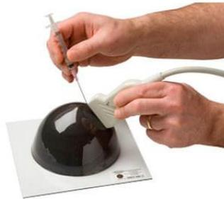
Figura 2.1. *Phantom* de mamografía Gammex 156D. Fuente [30].
