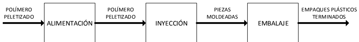
Figura 68. Diagrama de flujo por etapas del proceso de moldeo por inyección. Fuente: propia, agosto de 2016.
