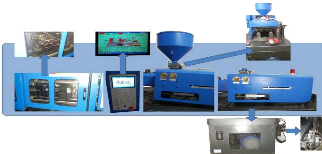
Figura 58. Máquina de moldeo por inyección del plástico. Fuente: propia, Junio de 2016.
