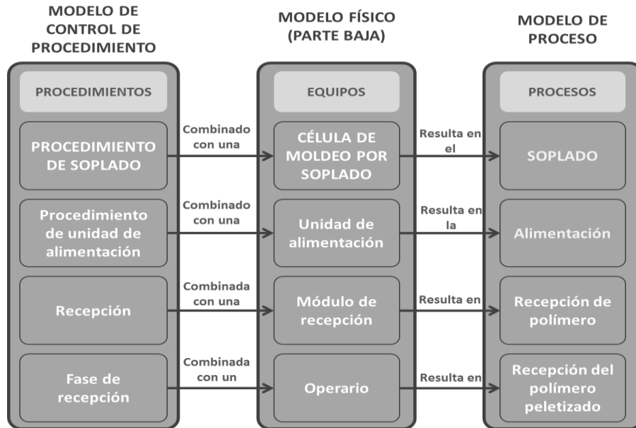
Figura 79. Relación entre modelos ISA-S88 para el proceso de moldeo por soplado. Fuente: propia, agosto de 2016.
