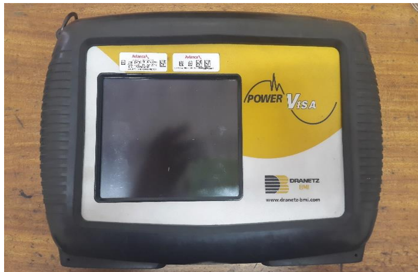
Figura 81. Analizador de red, Dranetz Power Visa. Fuente: propia, agosto de 2016.
