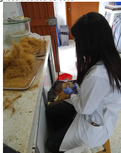
Figura 4. Adecuación de los residuos lignocelulosicos de coco
