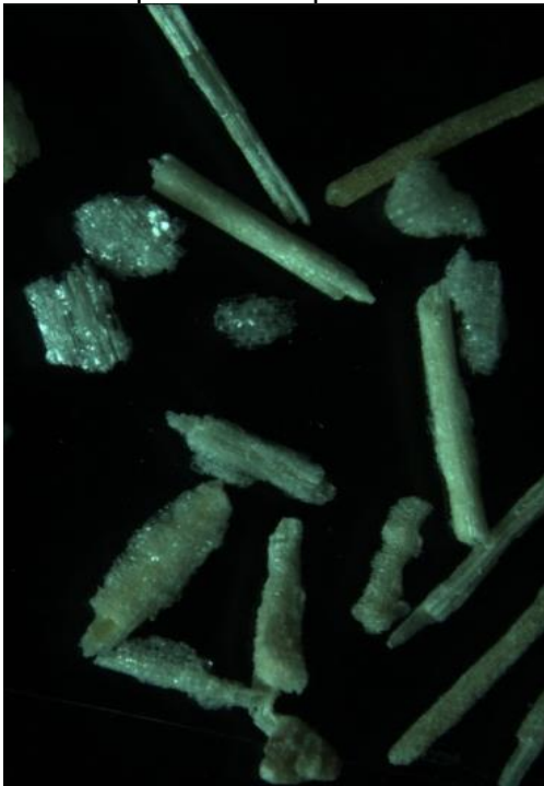
Figura 23. Bagazo de caña observado con estereoscopio retenido por la malla #30
