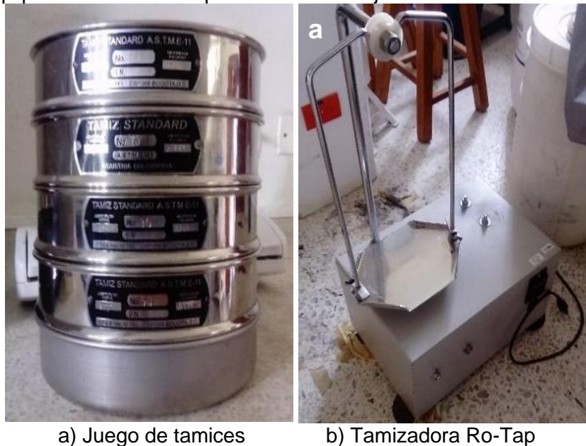
Figura 10. Equipos utilizados en el proceso de tamizaje
