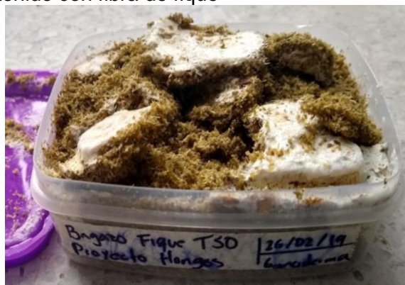
Figura 20. Material obtenido con fibra de fique
