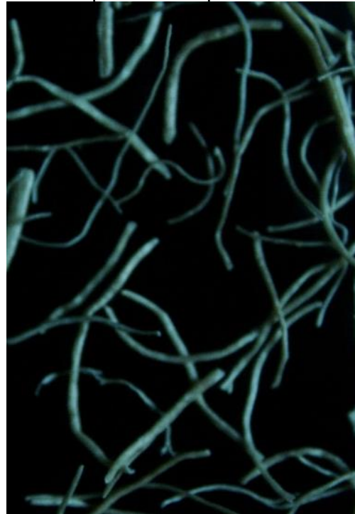
Figura 18. Fibra de coco observada con estereoscopio retenida por la malla #50
