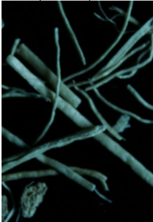
Figura 17. Fibra de coco observada con estereoscopio retenida por la malla #16
