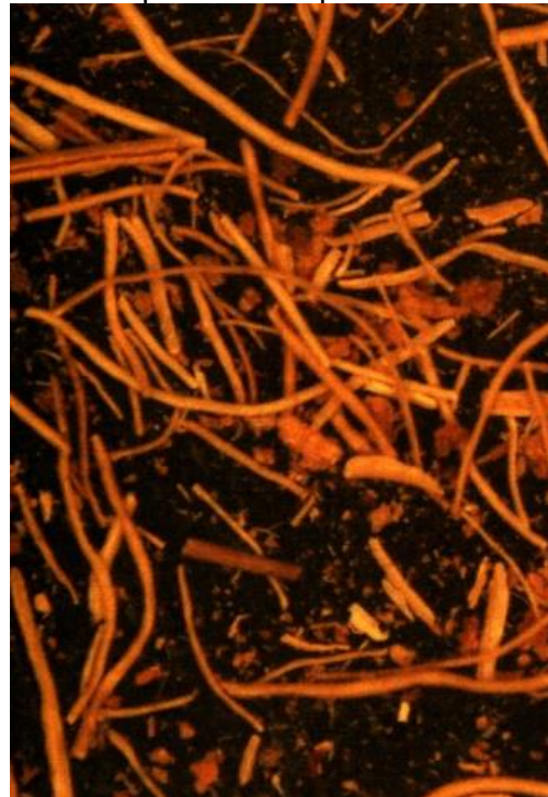
Figura 20. Fibra de coco observada con estereoscopio retenida por los fondos
