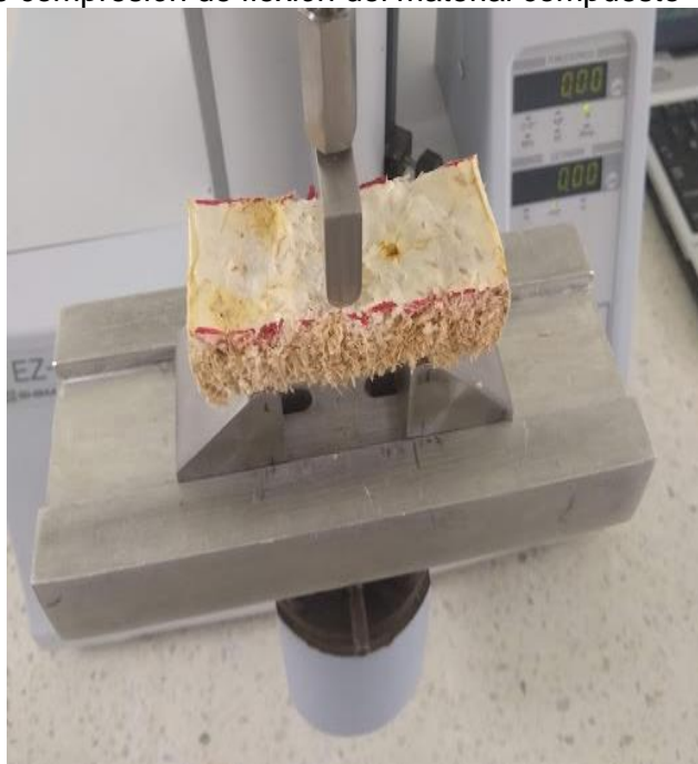
Figura 29. Prueba de compresión de flexión del material compuesto
