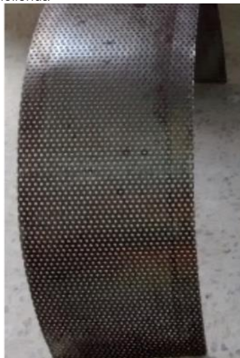
Figura 9. Criba utilizada en el proceso de molienda
