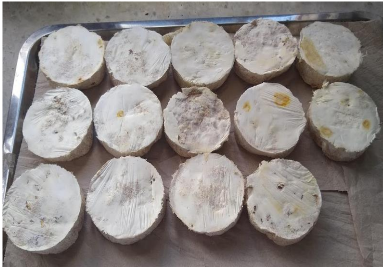
Figura 23. Especímenes de material obtenido con bagazo de caña de azúcar para pruebas de compresión
