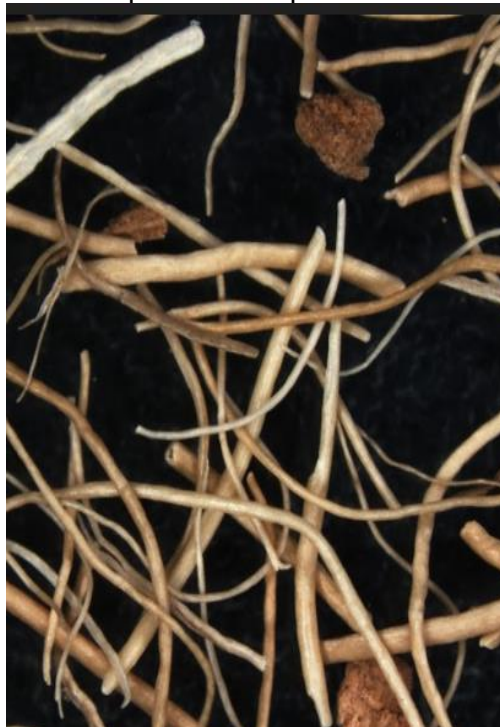
Figura 19. Fibra de coco observada con estereoscopio retenida por la malla #30
