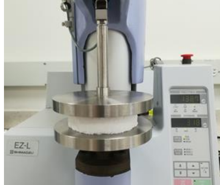
Figura 14. Máquina universal de ensayos adaptada para pruebas de compresión
