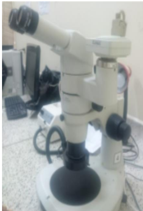
Figura 11. Estereoscopio usado en la caracterización de fibras
