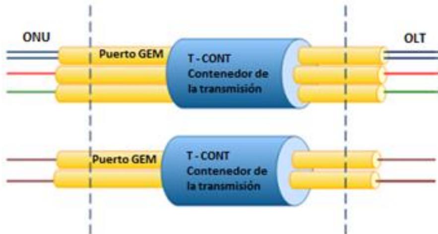
Figura B.3. T-CONT en los puertos GEM en el OLT y ONU [5].
