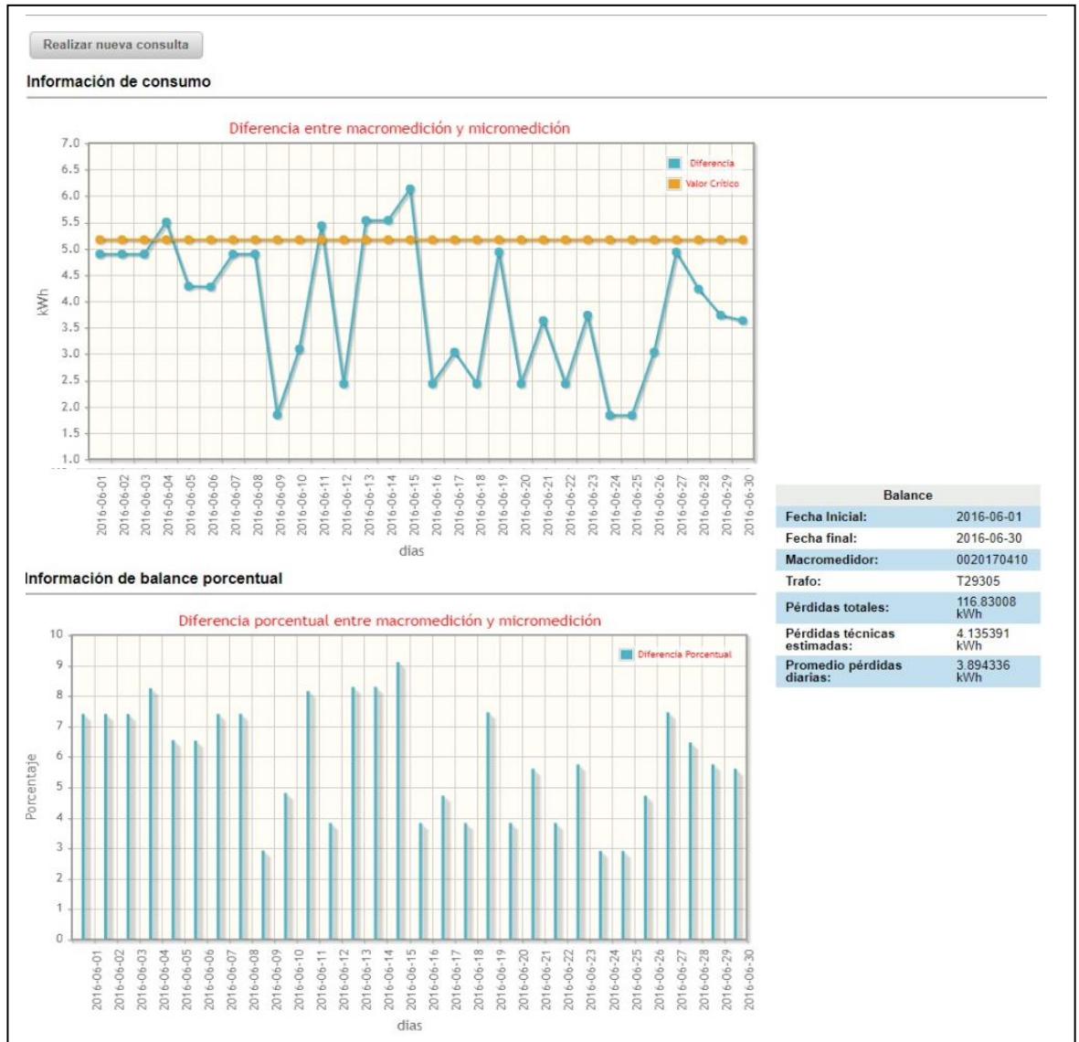
Figura 32. Balance de energía transformador T29305, entre junio 1 y junio 30 de 2016. Fuente: Aplicativo AMI-SAA.
