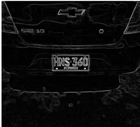
Figura 3.8 Resta de la erosión y la dilatación.
