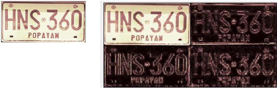
Figura 2.6 Descomposición wavelet en un nivel utilizando la wavelet Haar . Imagen original (izquierda), descomposición wavelet en aproximaciones y detalles (derecha).
