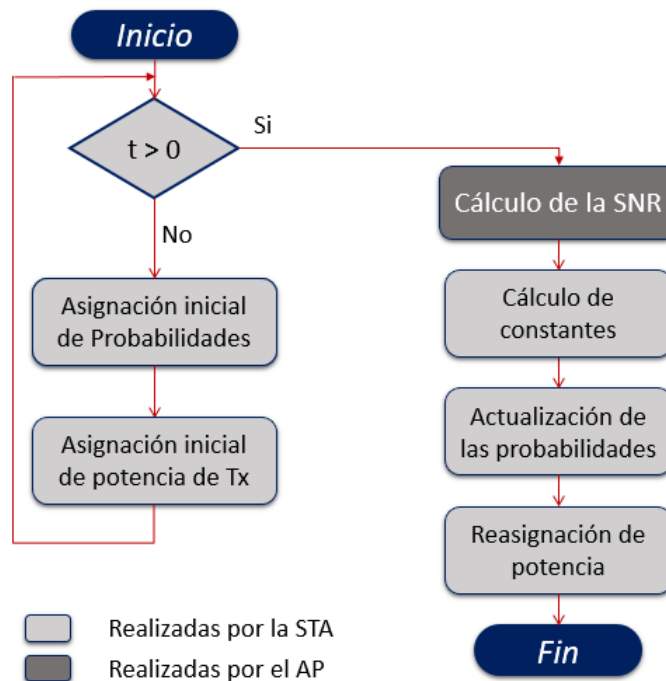
Figura 2.16 Diagrama de flujo del algoritmo de PC basado en GT. Por los autores.
