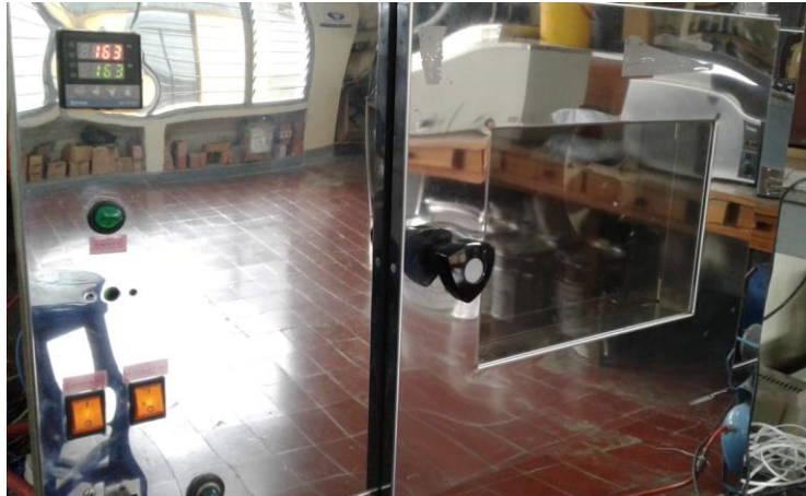
Figura 5 - 2 Horno de envejecimiento con la puerta cerrada y temperatura a 163 °C
