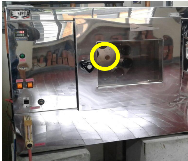
Figura 4 - 3 Seguro de la chapa de la puerta principal
