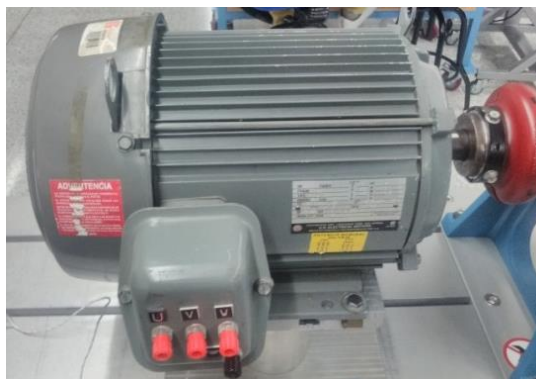
Figura 5.1. Motor de inducción trifásico en el que se ejecutó IEEE 112-B.
