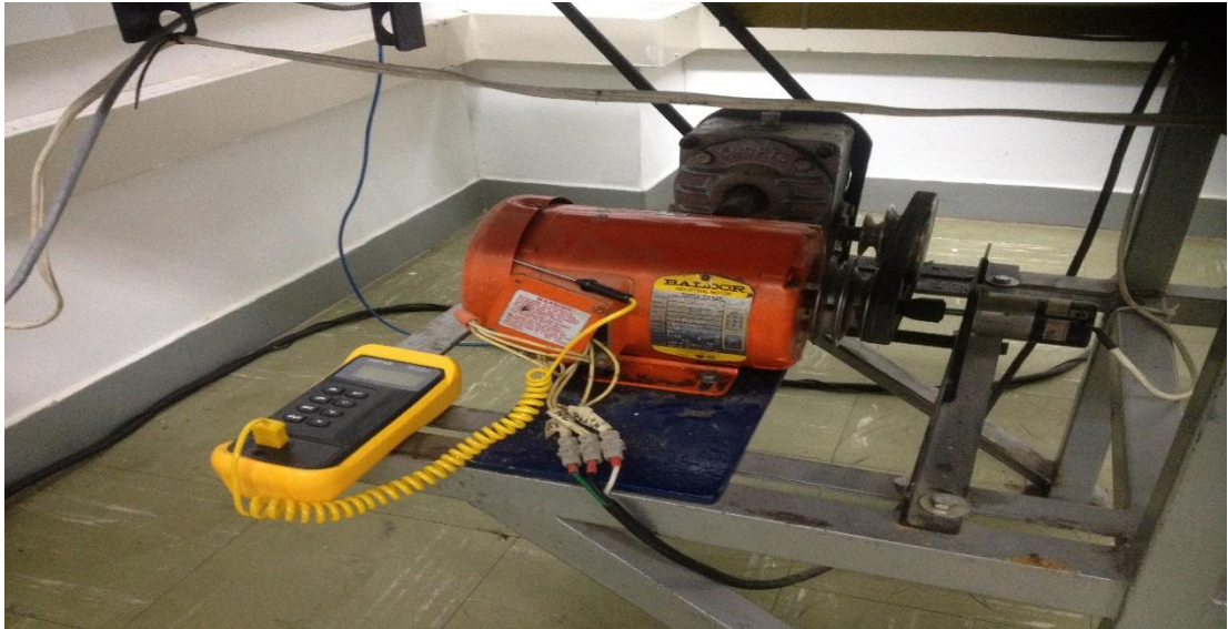
Figura 4.25: Calculo de temperatura del motor funcionamiento nominal
