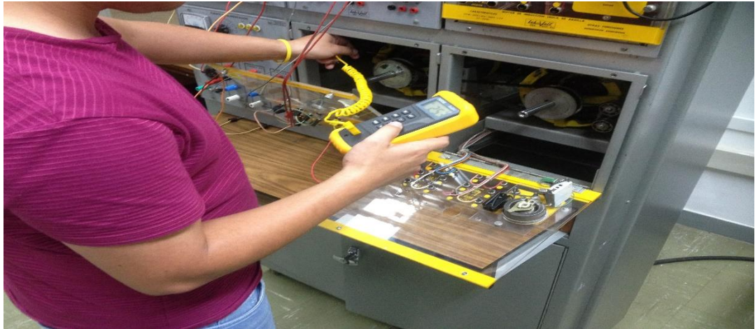
Figura 4.32: Medición de temperatura de los devanados del motor
