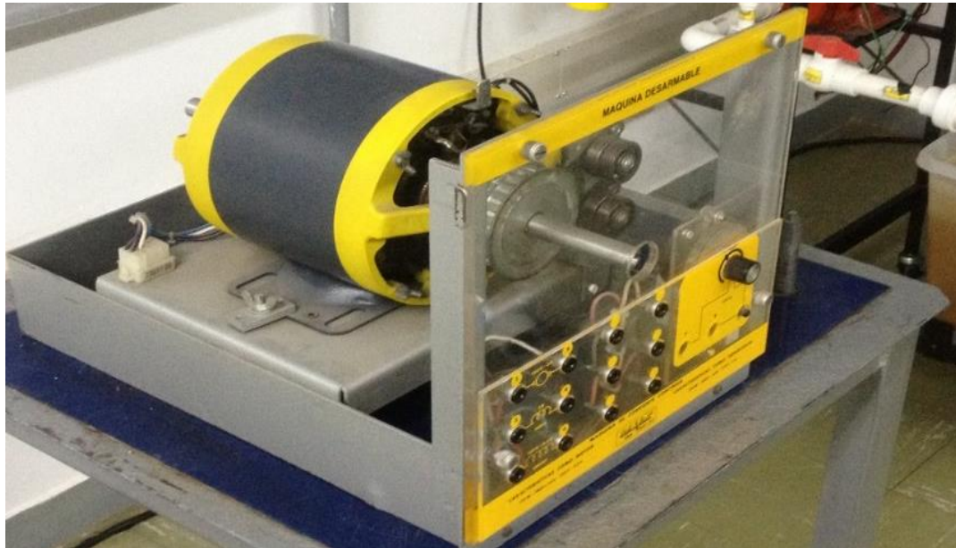
Figura 4.15: Motor eléctrico del EMDS de la planta de conversión de giro y frecuencia.
