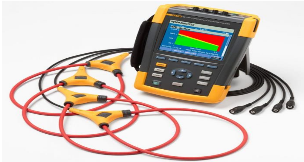
Figura 4.16: Analizador de variables del motor in situ y de calidad eléctrica.
