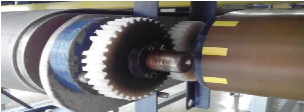
Figura 4.9: Sistemas de engranajes conectados a los ejes de los rodillos.
