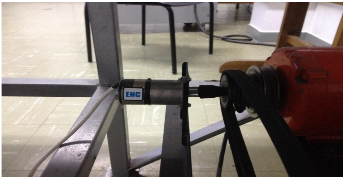
Figura 4.26: Medidor de revoluciones por minuto acoplado al eje del motor
