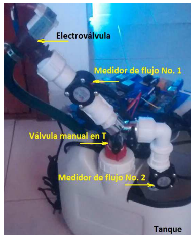
Figura 11 . Sistema hidráulico para la medición, corte y reconexión de agua domiciliaria.
