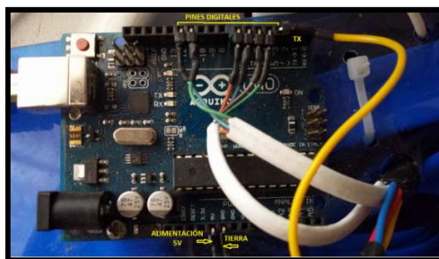
Figura 20. Conexión de pines utilizados para el procesamiento de señales.
