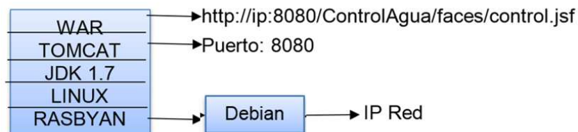
Figura 22. Estructura interna del software para conexión remota.
