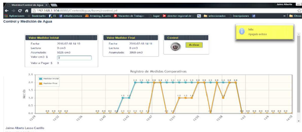
Figura 29. Desconexión del sistema y mensaje de apagado exitoso.
