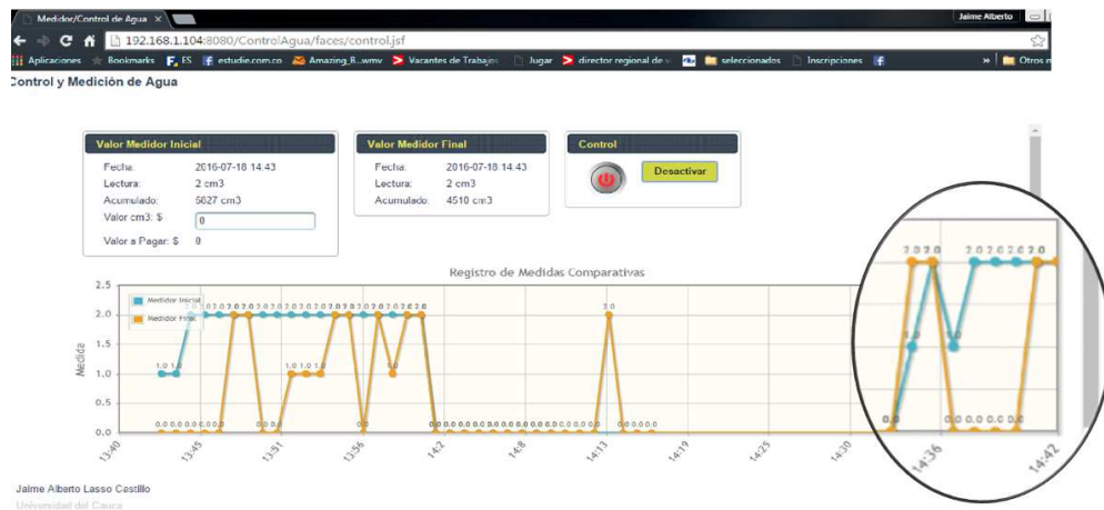
Figura 41. Restablecimiento de las mediciones de los sensores inicial y final.
