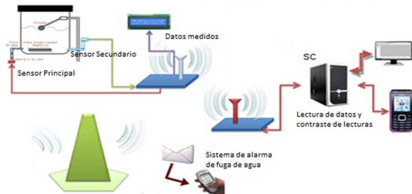
Figura 34. Esquema de detección de fugas por medición de flujo [50].
