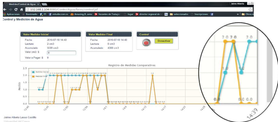
Figura 38: lectura del medidor inicial activa, medidor final en 0 cm 3 .
