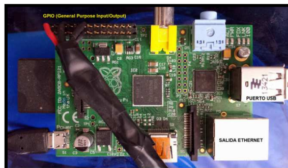
Figura 21. Conexiones de pines del Raspberry Pi para el procesamiento de señales.
