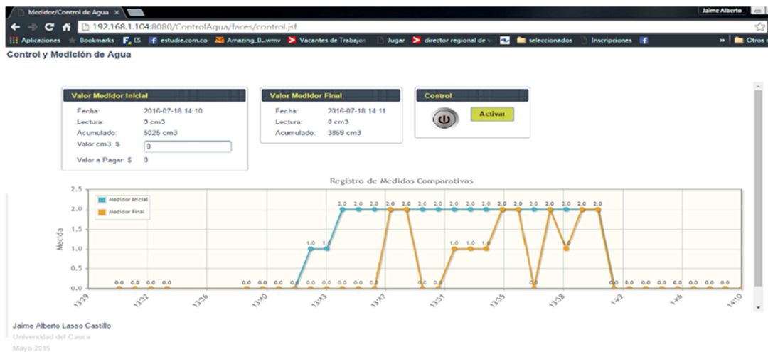
Figura 36: interfaz presentada con las diferentes lecturas de los medidores de flujo del sistema.
