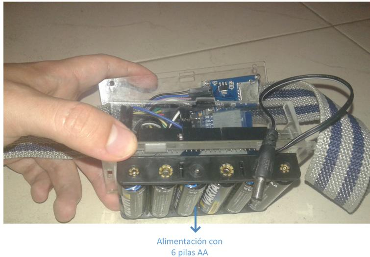
Figura 4.12: Dispositivo hardware en su version final (parte trasera).
