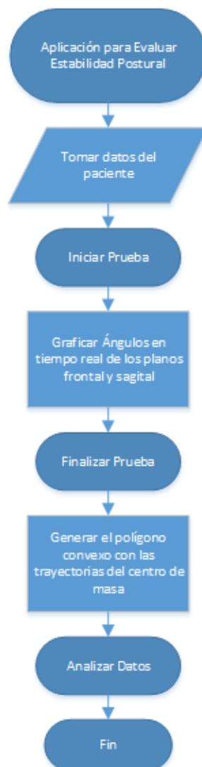
Figura 4.14: Diagrama de flujo del aplicativo para evaluación de estabilidad postural.
