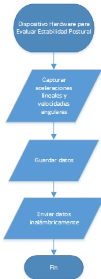
Figura 4.2: Diagrama de flujo para el dispositivo hardware.
