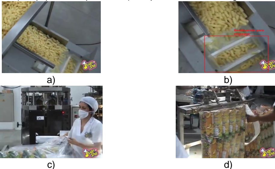
Figura 27. Etapa de empaqueo de JuanShis a). Recepción desde sazonado b). Separación para empaque c). Equipo de empaqueo d). Disposición en bolsas grandes
