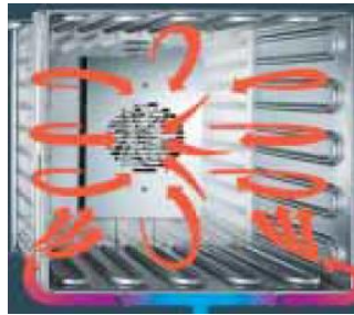
Figura 10. Circulación del aire del horno de convección forzada
