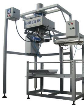
Figura 25. Máquina de embolsado y sellado
