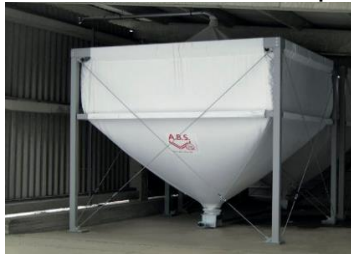
Figura 18. Silo flexible en lona para pellets
