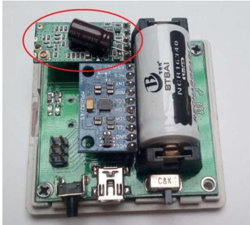
*Imagen 2. Módulo RF del sistema electrónico para monitorear vibraciones.*
