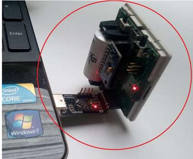
*Imagen 4. Conexión sistema electrónico para monitorear vibraciones con el PC.*
