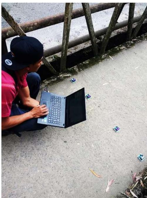
*Imagen 41. Módulos ubicados de forma horizontal con respecto al puente, fuente: Propia.*
