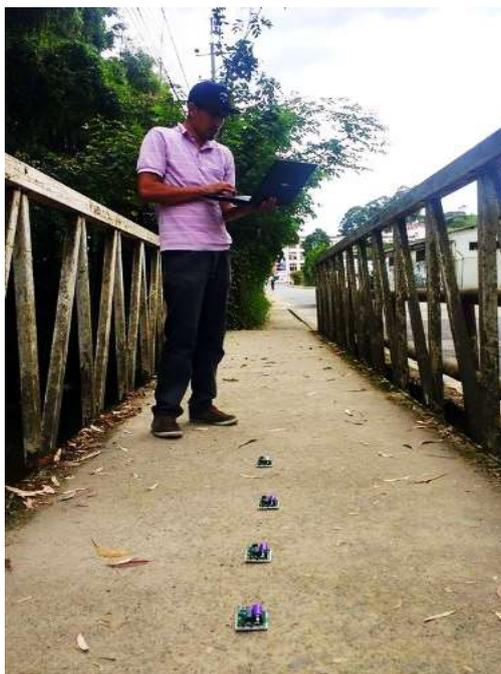
*Imagen 40. Módulos ubicados de forma vertical con respecto al puente, fuente: Propia*
