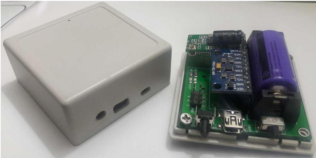
*Imagen 34. Sistema para monitorear vibraciones en puentes de viga caso de estudio, fuente: Propia.*
