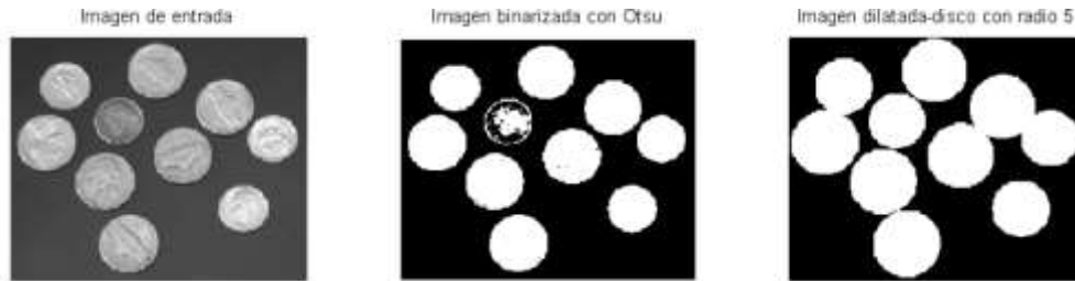
Figura 10: Dilatación binaria en una imagen digital. (tomada de [45])
