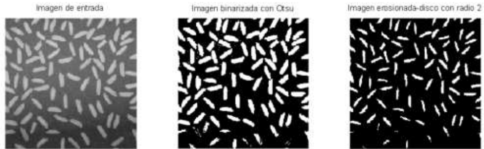
Figura 9: Erosión binaria de una imagen digital. (tomada de [45])
