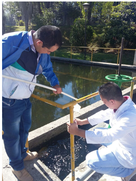
Figura 3.17: Muestras de agua tomadas en el acueducto. [Fuente: Propia]
