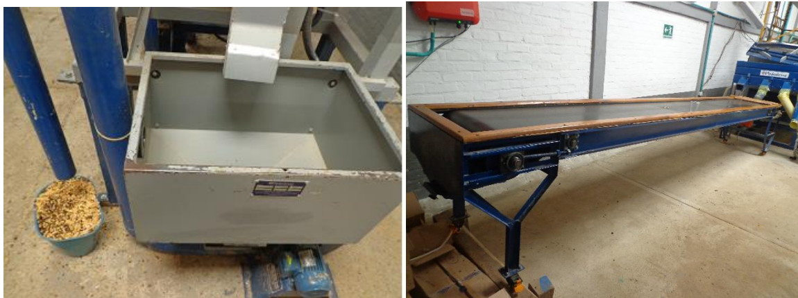
Figura 4 a) Tolva inicial y b) Banda transportadora. Fuente Propia
