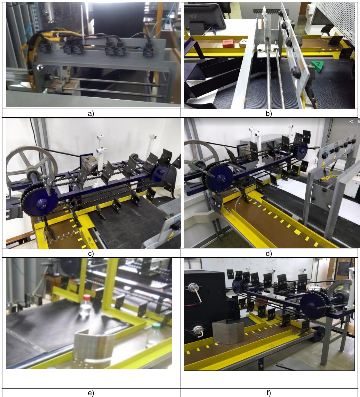
Figura. 61 Mejoras en el desplazamiento del clasificador
