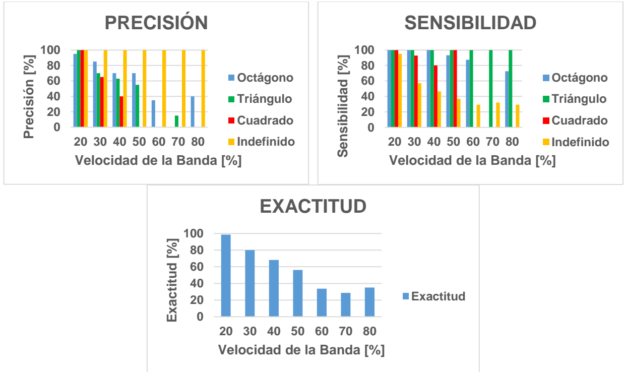
Figura. 81 Resultados de la Matriz de Confusión usando el algoritmo clasificador por Forma bajo esquema Dark Field
