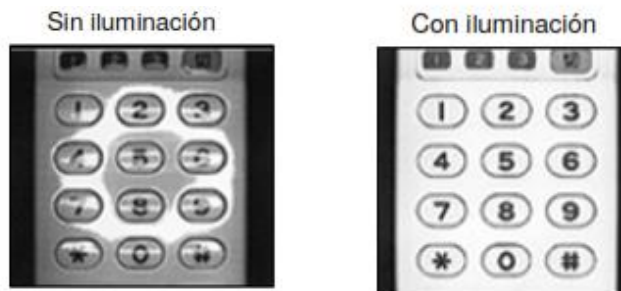
Figura. 23. Escenas captadas sin iluminación frontal (izquierda) y con iluminación frontal (derecha). Tomado de: Aplicación práctica de la visión artificial en el control de procesos industriales Conocimientos básicos de visión artificial, 2012.
