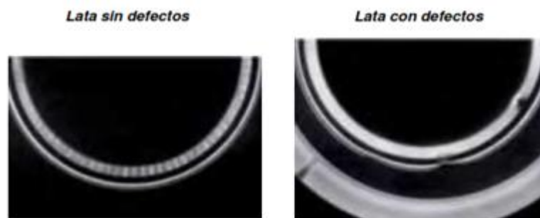
Figura. 29. Captura de imagen para esquema de Iluminación lateral, gracias a este esquema es posible extraer características muy puntuales de un objeto.
