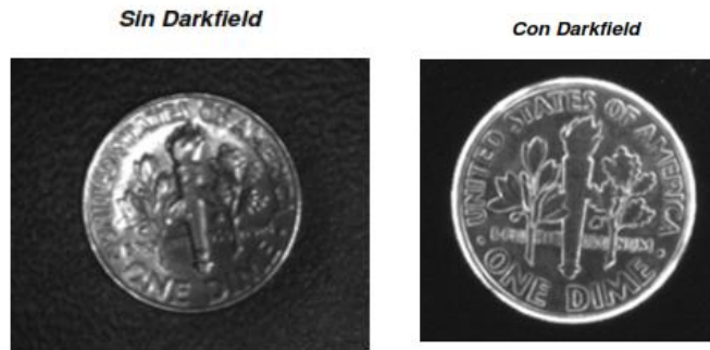
Figura. 25. Captura de imagen para esquema de Iluminación Frontal.
