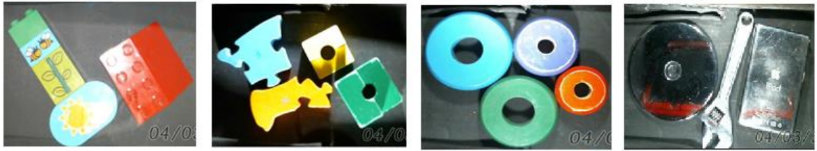
Figura. 49. Piezas de prueba utilizadas con diferente iluminación capturas con una cámara Logitech C210 utilizando un PC [Fuente propia]
