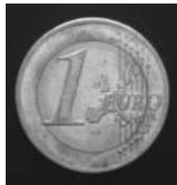
Figura. 26. Captura de imagen para esquema de Iluminación Dark Field sobre una moneda.
