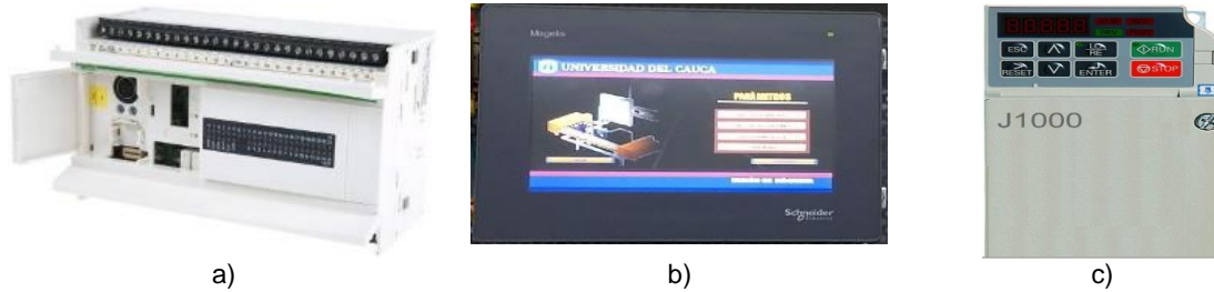
Figura. 36. Elementos seleccionados para la Planta Clasificadora. a) PLC. b) PanelView. c) Variador.
