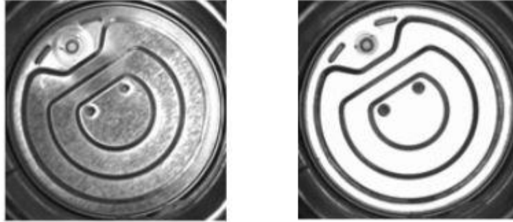
Figura. 27. Captura de imagen de elemento altamente reflectante mediante esquema de iluminación Coaxial. Tomado de: https://microscan.s3.amazonaws.com/Espanol/NERLITE_brochure_espanol.pdf
