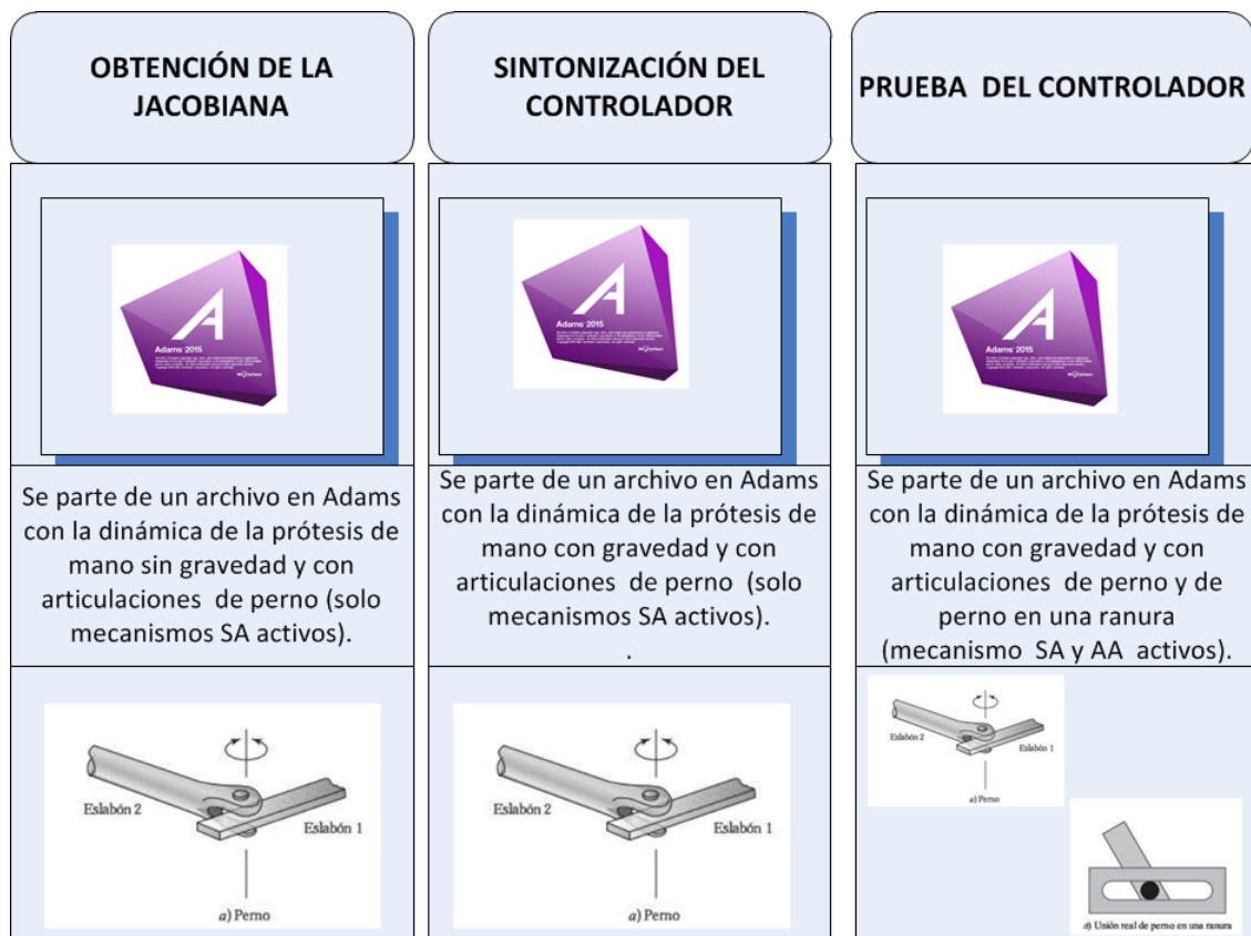
Figura 3.12: Fases y condiciones para realizar el control PID en el espacio de tarea para la prótesis de mano.
