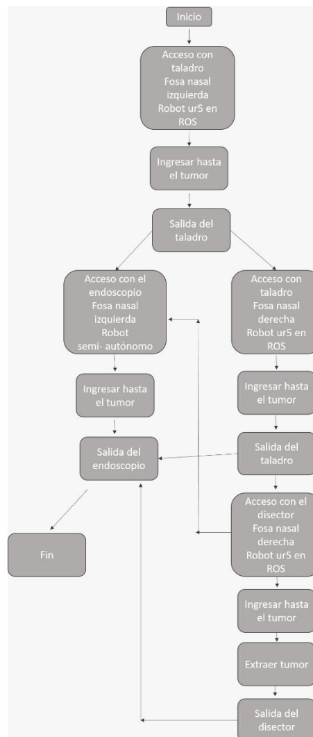
Figura 50. Diagrama de flujo del procedimiento de la simulación.
