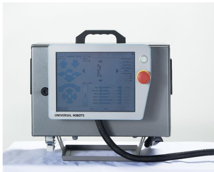
Figura 5. Caja de control y consola de programación [30].
