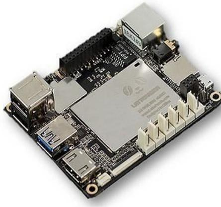
Figura 3.5: Procesador LattePanda. Fuente [www.lattepanda.com](http://www.lattepanda.com)
