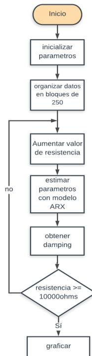
Figura 4.8: Diagrama de Flujo para la representación del código implementado en el análisis de las pruebas con resistencia variable modificando el coeficiente de amortiguamiento electromagnético.
