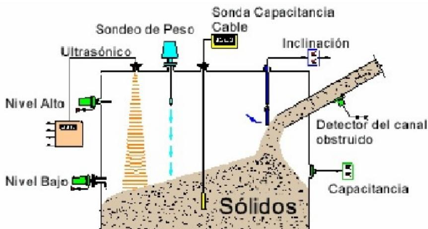
Figura 1.3: Ejemplos de sensor de nivel para sólidos.
