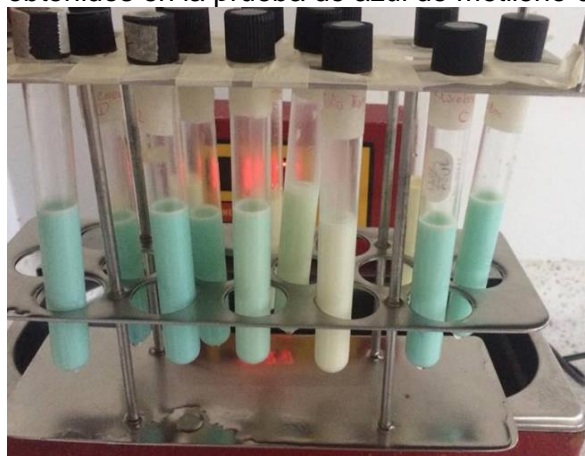
Figura 12. Resultados obtenidos en la prueba de azul de metileno después de 30 min
