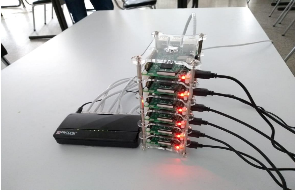
Figura 17. Cluster conformado por 6 Raspberry Pi. Donde el primer dispositivo de arriba hacia abajo es el maestro y los otros cinco son los esclavos Fuente: Propia.
