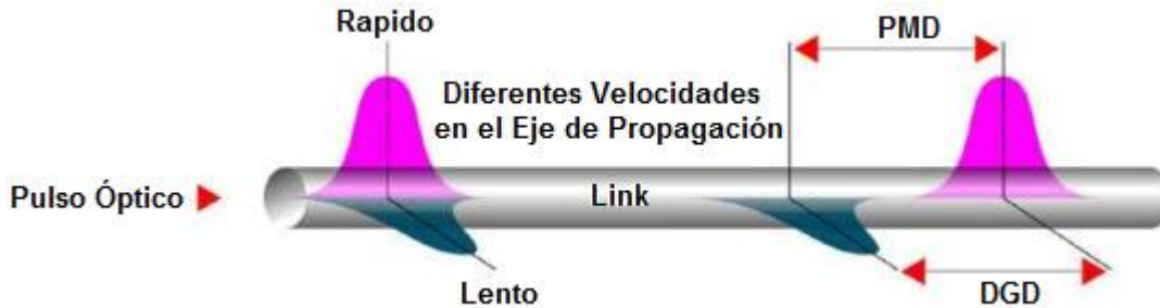
Figura 1.16 Efecto PMD sobre un enlace de Fibra [32]
