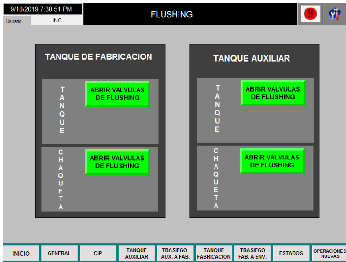
Figura H.25: Ventana emergente operación flushing
