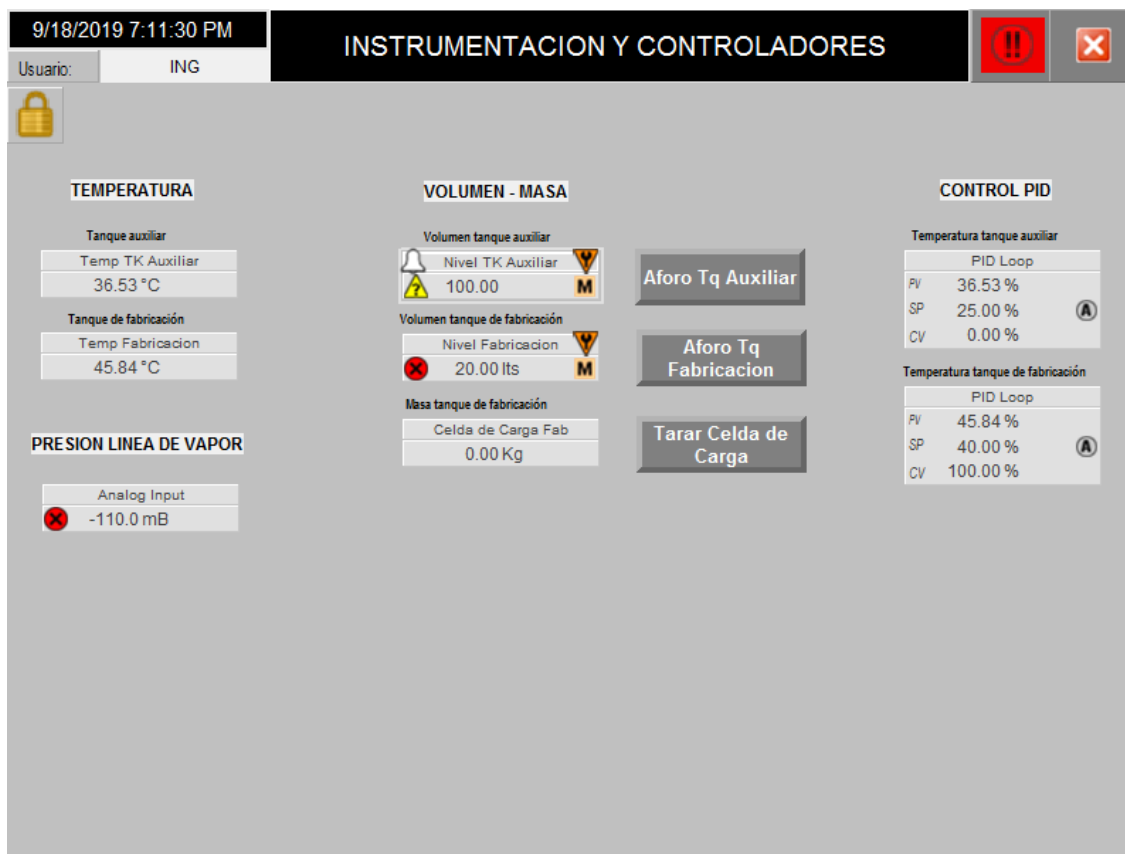
Figura H.11: Pantalla instrumentación y controladores
