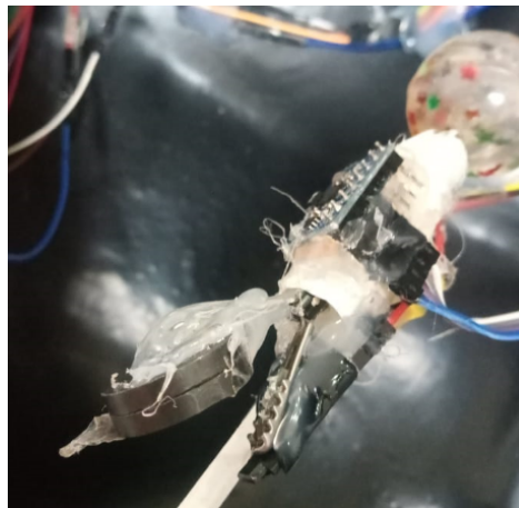
Figura 32: Sensor de efecto Hall en Pinza Laparoscópica. Fuente: Propia.
