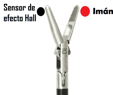
Figura 26: Imagen de pinza con sensor de efeco Hall. Fuente: Elaboración propia.
