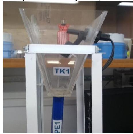
Interruptor de nivel y tanque acrílico
