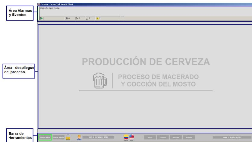
Figura 2.6: Áreas del sistema de supervisión
