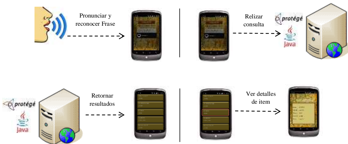
Figura 15. Diagrama de interacción entre el usuario, el dispositivo móvil y el servidor Web
